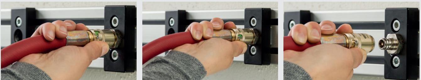
Das Entkuppeln erfolgt durch ein manuelles zwangsgeführtes Zurückschieben der Kupplungshülse. Erst durch eine bewusste Zieh- bzw. Drehbewegung kann der Stecknippel gelöst und von der Sicherheitskupplung entnommen werden.
