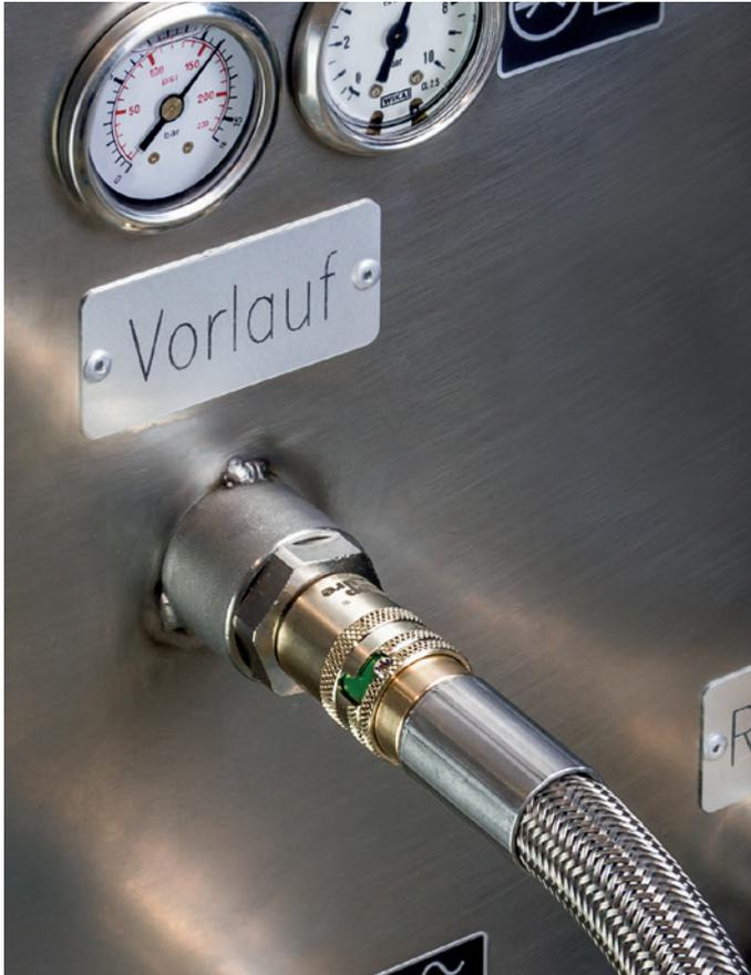
Das patentierte TempSecure by **LUDECKE**® Temperier-Schnellverschlusskupplungssystem verfügt über eine automatische Sicherheitsverriegelung und verhindert damit ein unbeabsichtigtes Entkuppeln und Entriegeln.
