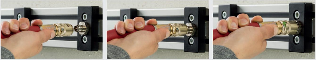
Kuppeln mit Einhandbedienung - Zur Verbindung den Stecknippel in die Sicherheitskupplung eindrücken. Die Verriegelungshülse rastet dann aufgrund der automatischen Sicherheitsverriegelung mit einer Verdrehung von selbst nach vorn in die endgültige Sicherungsposition ein. Die Kupplung ist nun fest mit dem Stecknippel verbunden und gegen unbeabsichtigtes Öffnen gesichert.
