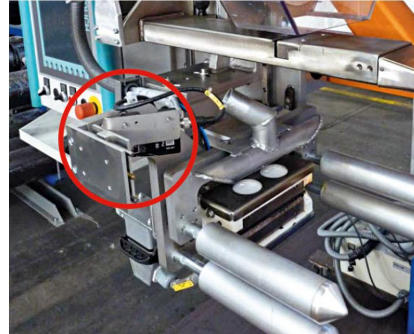
Kantensensor. Hier am linken Schneid- und Schweißgerät
