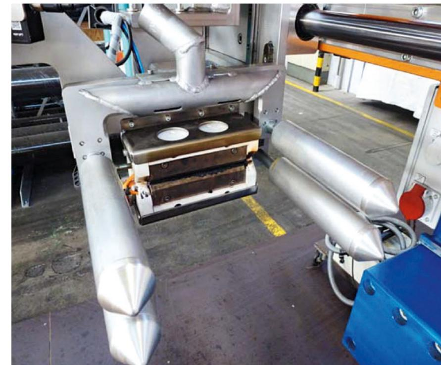
Führungsrollen mit mittig angeordneten austauschbaren Schweißbacken
