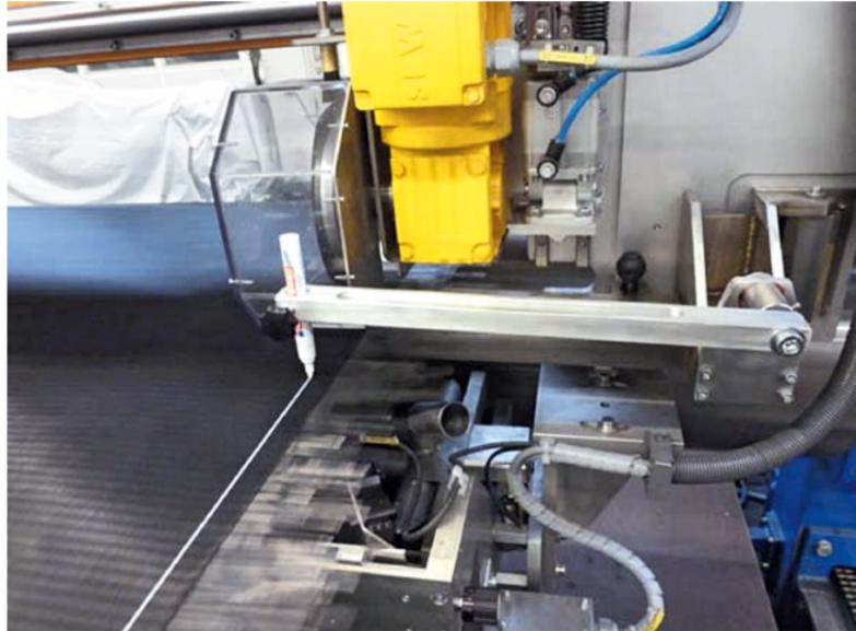
Sollte der Filz nicht gleichmäßig ausgerichtet sein wird dies durch die gesetzte Markierung sofort sichtbar, so dass der Filz nachgerichtet werden kann.
