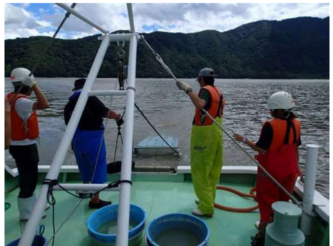
桁網による底生生物採集
