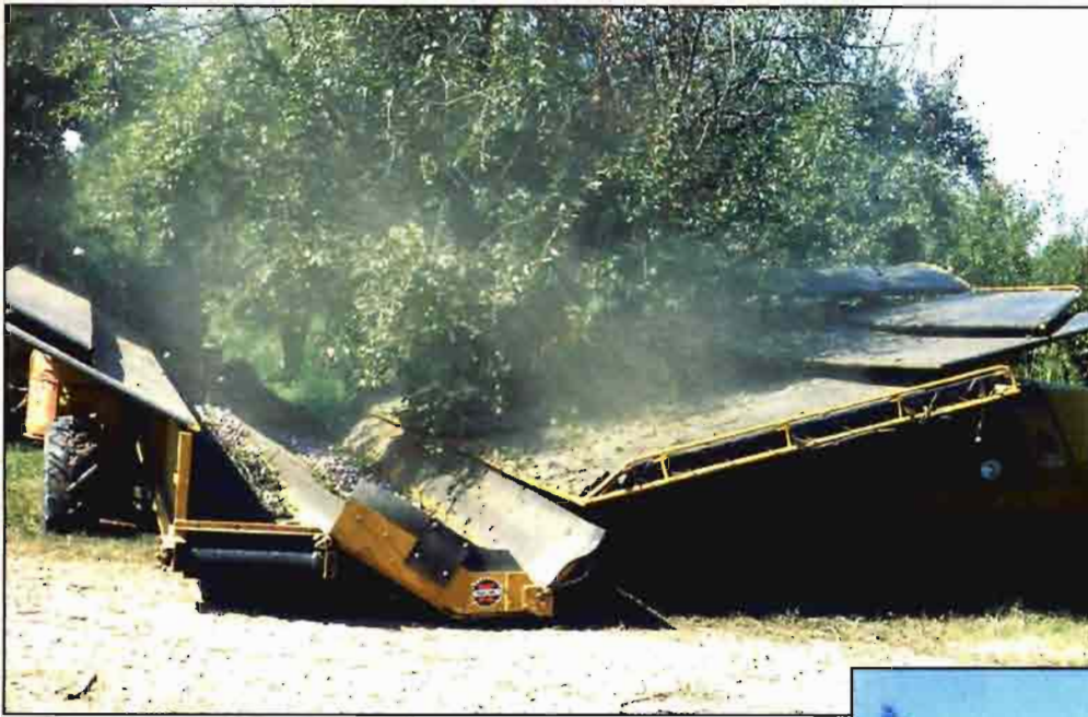
Máquina vibradora dotada de receptáculo para recoger las aceitunas.
