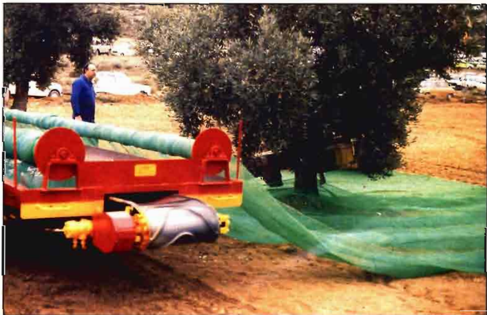
Momento de la colocación de una red para recoger las aceitunas que se desprendan con el vibrador.
