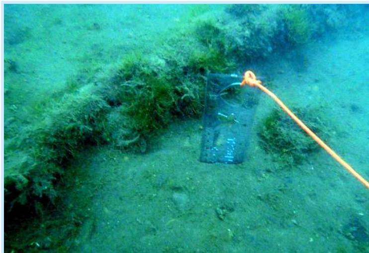
Imatge 16. La mesura de la sedimentació en els diferents punts de mostreig es determina amb un regle mil·limetrat que s'insereix en 6 punts diferents en cada zona de control des de la Z1 a la Z7. La dada final de sedimentació de cada punt de mostreig és el resultat de la mitjana de les mesures realitzades.
