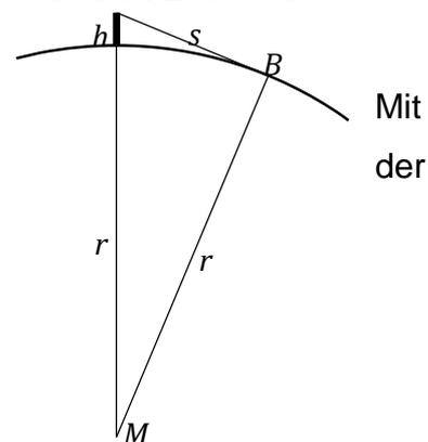
Zur Berechnung der Sichtweite reicht der Satz des Pythagoras aus. Eine Verwendung von Winkelfunktionen ist nicht erforderlich. Hierbei ist die Summe aus  $r$  und  $h$  die Hypotenuse,  $r$  und  $s$  sind die Katheten, denn der Rechte Winkel liegt im Berührungspunkt  $B$  des Sehstrahls.
