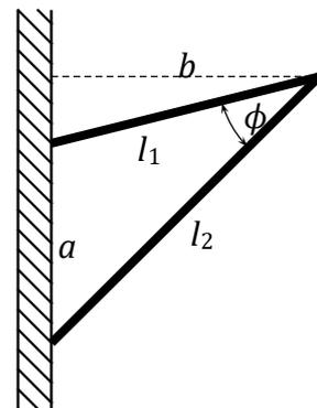
$$\begin{aligned} a^2 &= l_1^2 + l_2^2 - 2 \cdot l_1 \cdot l_2 \cdot \cos \varphi && |\sqrt{\phantom{x}} \\ a &= \sqrt{l_1^2 + l_2^2 - 2 \cdot l_1 \cdot l_2 \cdot \cos \varphi} \\ &= \sqrt{(3 \text{ m})^2 + (4 \text{ m})^2 - 2 \cdot 3 \text{ m} \cdot 4 \text{ m} \cdot \cos 25^\circ} \\ a &\approx 1,802 \text{ m} \end{aligned}$$
