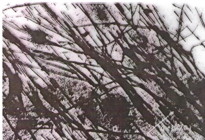
Abbildung 70: Transmissionselektronenmikroskopische Beobachtung von Versetzungen in verformtem NaCl. Schnitt parallel zur Gleitebene.
