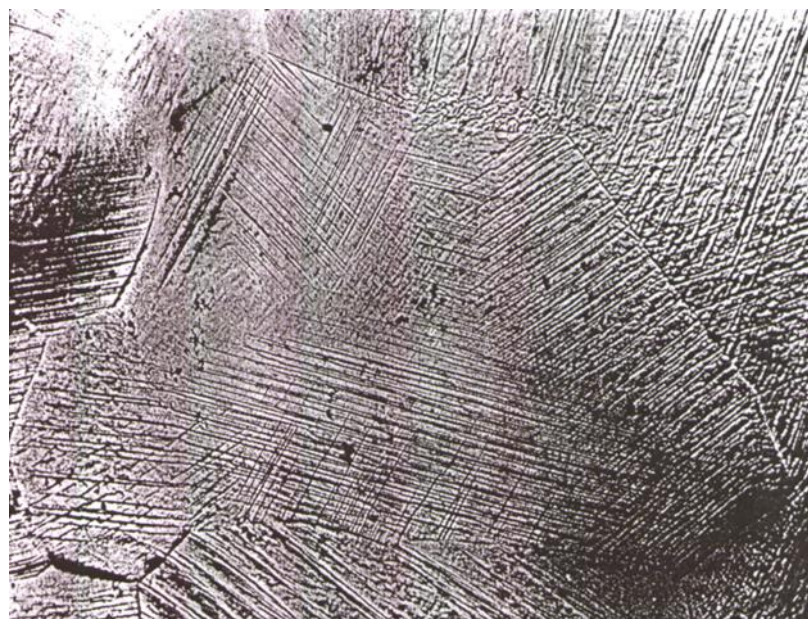
Abbildung 33: Mehrfachgleitung in Al-Vielkristall
