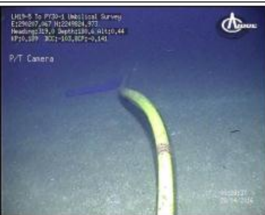
图 3.2-1b 脐带缆处打扭
