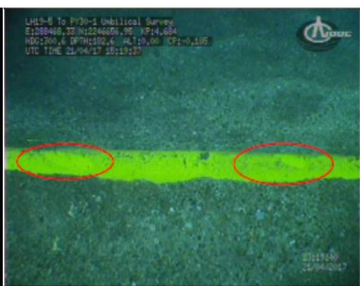
图 3.2-1d 脐带缆处有划痕
