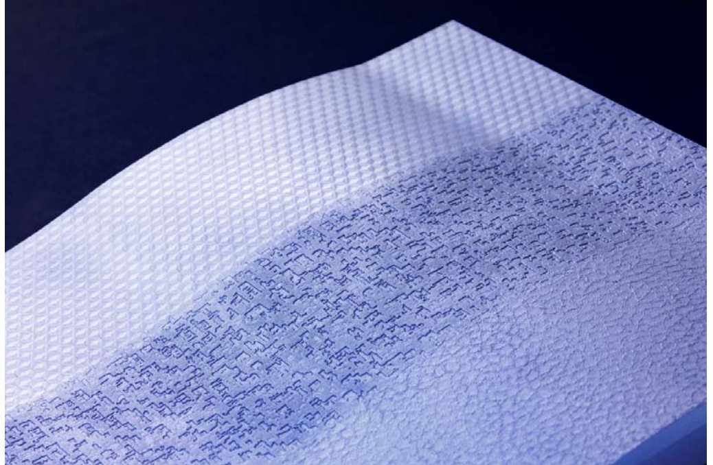
Laserstrukturierter Formeinsatz für das Kunststoffspritzgießen von Bauteilen zur Innenausstattung von Mittelklassewagen
