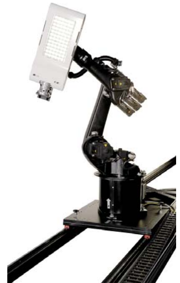
Das opsira robogonio - Multifunktionales Lichtmessgoniometer
