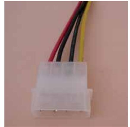
Fig. 4.7. Conector de alimentación para disco IDE.
