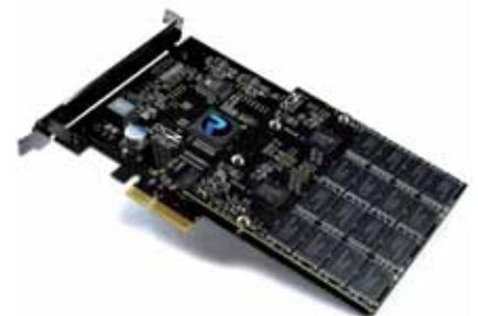
Fig. 4.13. Unidad SSD con conexión PCI Express.
