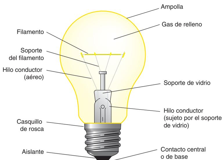
Fig. 4.1. Partes de una lámpara.
