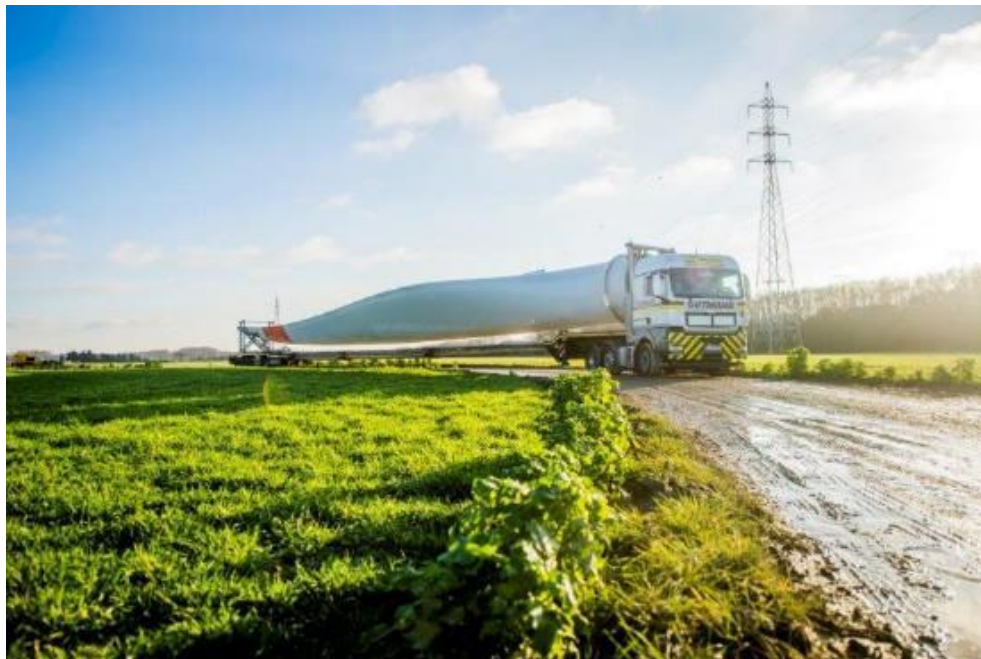
Illustratie 3.4: Uitzonderlijk transport. Deze foto toont het transport van een wiek
