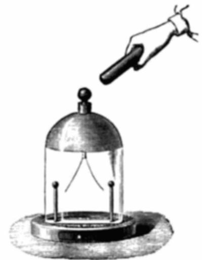
Un electroscopio usado para medir la carga eléctrica de un objeto.
