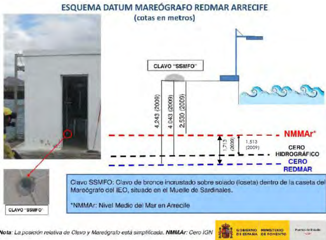
Ilustración 2:- Relación entre el cero REDMAR y el NMMAr. Fuente: Puertos del Estado
