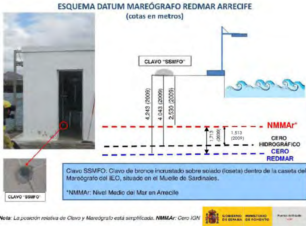
Ilustración 14:- Relación entre el cero REDMAR y el NMMAr. Fuente: Puertos del Estado
