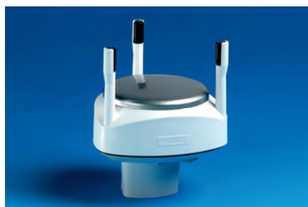
超音波型風向風速計
