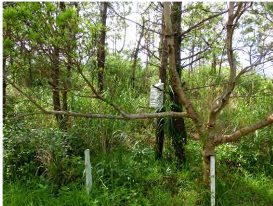
百葉箱内に温湿度センサーを設置
