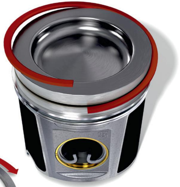
Abb. 1: Verdrehen und Aufspreizen der Kolbenringe beim Aufziehen auf den Kolben
