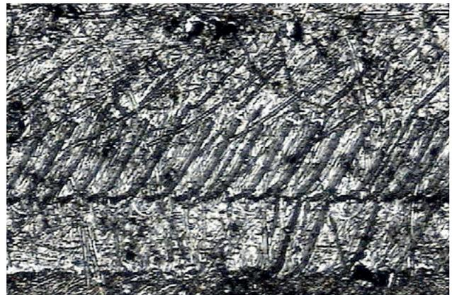
Abb. 4 und 5: Beispiele für Rollspuren an der oberen Ringflanke
