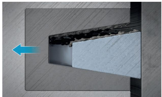
**Reinigungsfunktion:** Aufgrund der Formgebung der Trapezringe und deren Bewegung in der Ringnut durch das Kolbenkippen (siehe Kapitel 1.6.11 Kolbenringbewegungen) werden Verkokungen mechanisch zerrieben.
