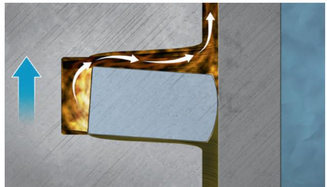
Abb. 3: Verdichtungstakt
