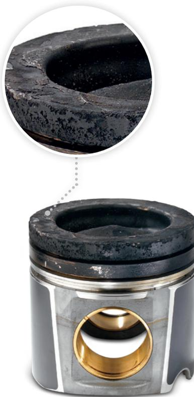
Abb. 3: Ölkohleschicht am Feuersteg
