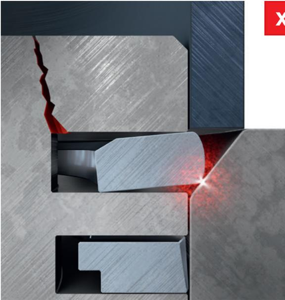
Abb. 1: zu große Fase an der Zylinderbohrung – der Kolbenring federt bei der Montage zwischen Kolbenringspannband und Zylinder aus und der Kolben blockiert
