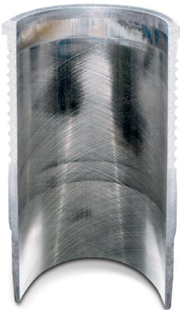
Abb. 2: Glanz und Polierstellen im oberen Zylinderbereich
