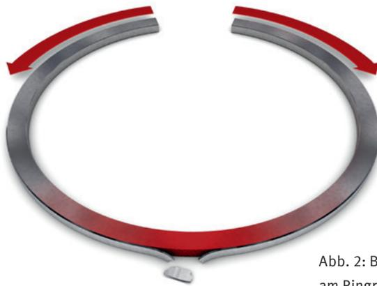
Abb. 2: Beschichtung bricht am Ringrücken aus.
