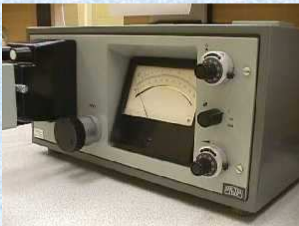
Spekol 10 - jednopaprskový výchylkový spektrofotometr
