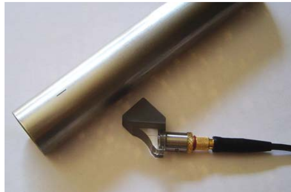
Abb. 2. Prüfkopf für die Längsfehlerprüfung
