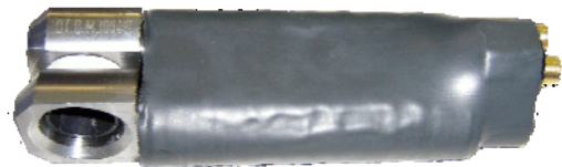
Abb. 8. Wirbelstromsensor mit Magnetisierungsspulensystem
