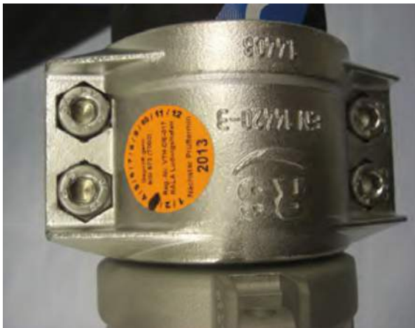
Abbildung 17: Beispiel einer farbigen Plakette zur leichteren Erkennbarkeit des nächsten Prüftermins
