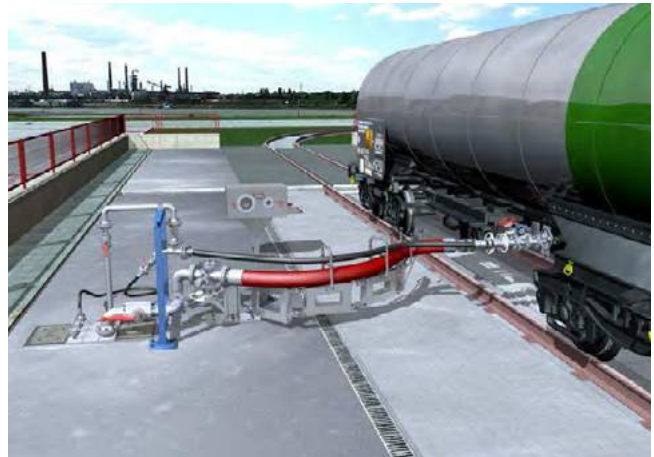
Abbildung 13a: Verlegen von Schlauchleitungen – Schlauchgelenkarm
