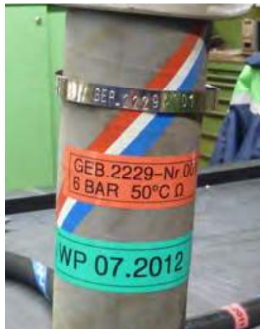
Abbildung 18: Beispiel einer gekennzeichneten Schlauchleitung
