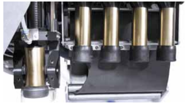
Limpeza dos copos de ordenha por dentro e por fora
