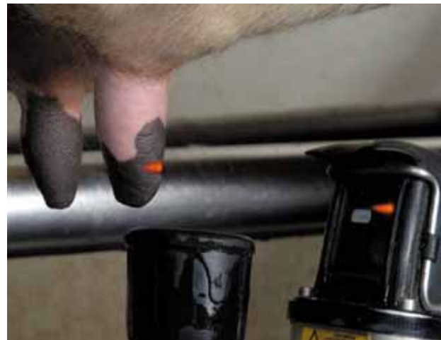
Sistema de “visão” do braço com câmara óptica e duplo laser
