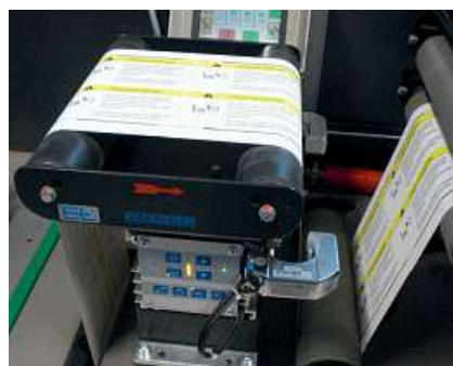
ELGUIDER DRS20 in Digitaldruckmaschine
