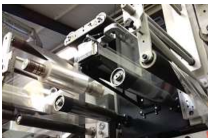
ELGUIDER DRB14 an Verpackungsmaschine
