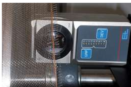
Infrarot-Kantensensor FR 52 für Gittergewebeerfassung
