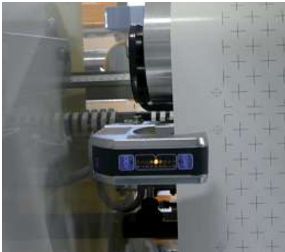
Ultraschall-Kantensensor FX 46 an Papierkante
