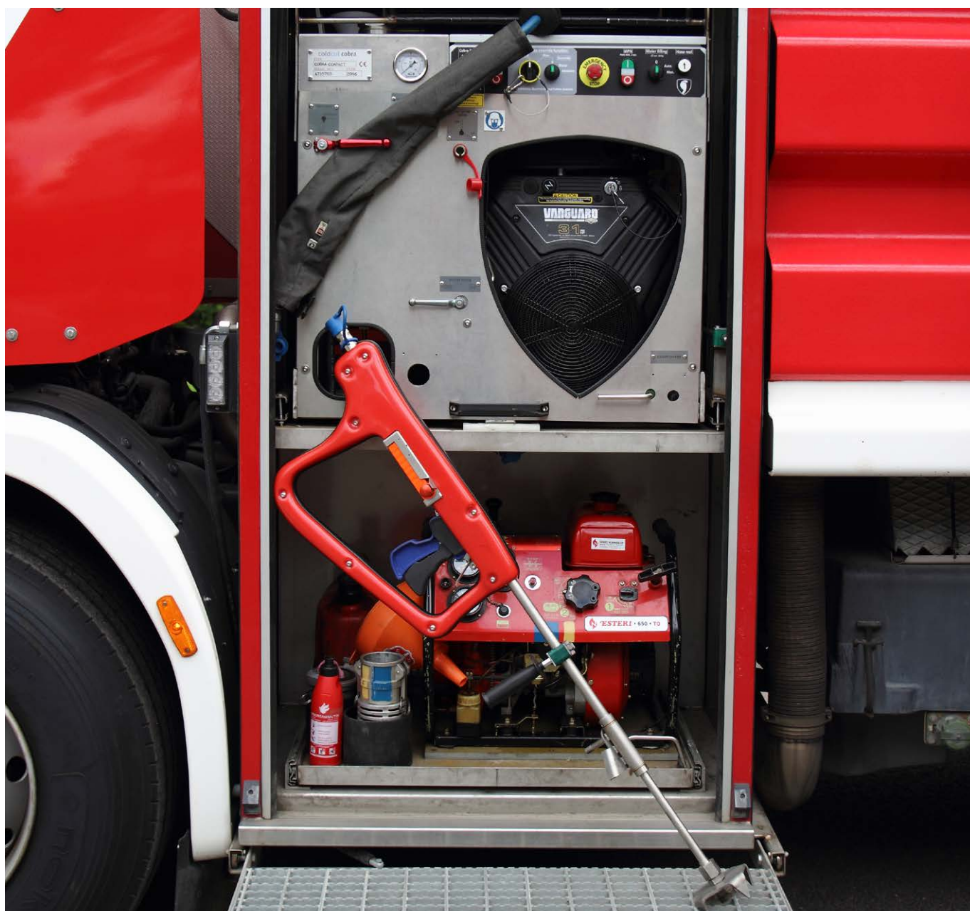
Bild 4. År 2017 beviljade Brandskyddsfonden Tirilän VPK 19 493 euro för anskaffning och montering av en skärsläckare. Skärsläckaren monterades på tankbilen EK133. Vattenflödet i skärsläckaren Cold Cut Cobra Compact är 37–42 l/min, 180–200 bar. Den har en egen bensinmotor och är kopplad till tankbilens vattentank. Skärsläckaren tränger igenom olika material med hjälp av ett skärmedel (abrasiv) och används bl.a. vid bränder i tillslutna utrymmen, hållrum och andra svårtilgängliga utrymmen. Vattenmängden är liten, vilket minskar risken för följdskador. Tirilän VPK är Södra Karelens räddningsverks avtalsbrandkår och finns i Villmanstrand. Bild: Marko Tervonen/Tirilän VPK
