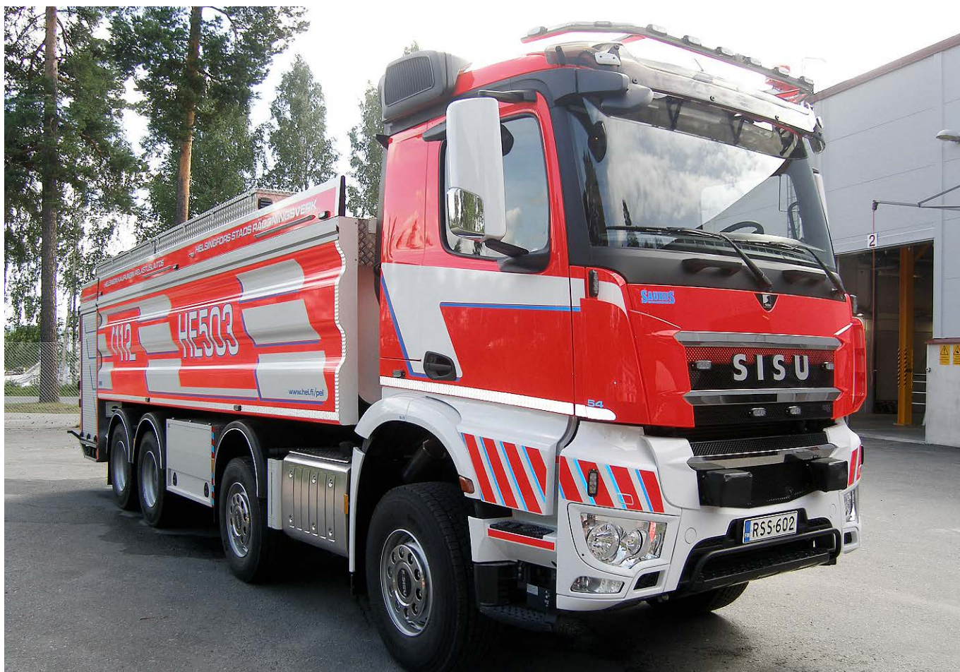
Bild 2. År 2017 beviljade Brandskyddsfonden Helsingfors stads räddningsverk 56 000 euro för anskaffning av en tankbil. Den nya Sisu Polar-tankbilen HE503 finns vid Malmis räddningsstation. Viktiga kriterier för den tunga bilens egenskaper var att den ska vara smidig och lätt att manövrera i stadsmiljö. Utrustningen består av en vattentank på 17 000 liter, en skumväsktank på 1 000 liter, en Esteri-brandpump och en vattenkanon. Brandpumpens maximala effekt är 6 000 liter i minuten. Tanken har fyra utgångar varav tre kan användas direkt som källa för vattnet till brandsprutorna och den fjärde särskilt för att mata vatten till släckningsbilarna. Bild: Reijo Julkunen
