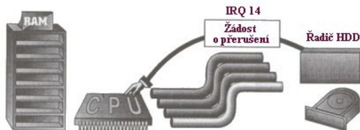
Znázornění vyvolání přerušeni IRQ 14
