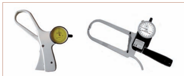
Figura 5. Dos modelos diferentes de medidor de pliegues cutáneos ( skinfold caliper ). Estos calibres tienen, como característica fundamental, la de ejercer una presión constante de 10 \text{ g/mm}^2
