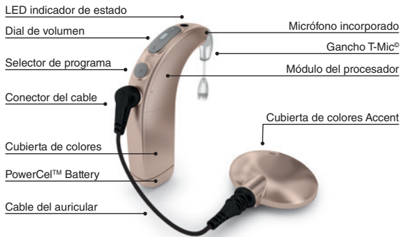
Parte externa del implante coclear
