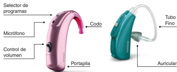
Componentes externos del audífono. (Izq. modelo retroauricular. Der. modelo CRT o RITE)
