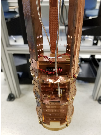
FIGURE 13.2 : Étage supplémentaire ajouté au bas du cryostat permettant d’être au milieu de l’aimant sur lequel l’échantillon est mis en place.
