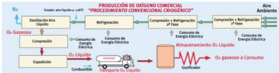
Ilustración 5. Proceso convencional criogénico para la producción de oxígeno (Fuente: Instituto para la Diversificación y Ahorro de la Energía)
