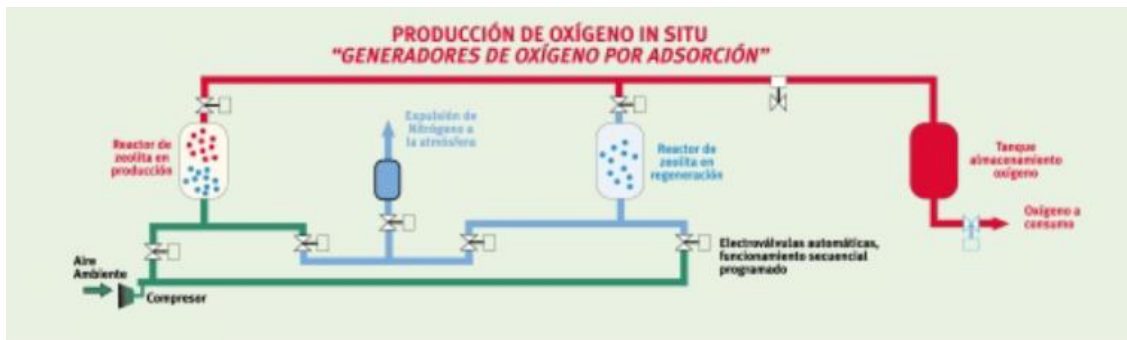
Ilustración 6. Proceso para la producción de oxígeno in situ por adsorción (Fuente: Instituto para la Diversificación y Ahorro de la Energía)
