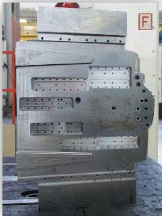
Seitenansicht des Kernsegments für die Kunststoffspritzgussform: Alle Temperierbohrungen, Gewinde und Passungen sind mit MT-F-Technologie und NC-Sets programmiert worden
