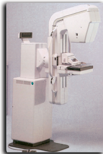
Mamógrafo. Se puede apreciar el portachasis donde se posiciona la mama, el compresor y el cono localizador
