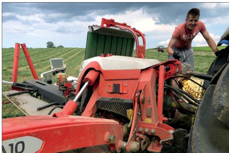
Žáci kombinace NovaCat A10 Collector se těší profesionální a pravidelné údržbě od obsluhy traktoru Zbyňka Fialy. Její součástí je i vyfoukání nečistot pomocí hadice a koncovky
