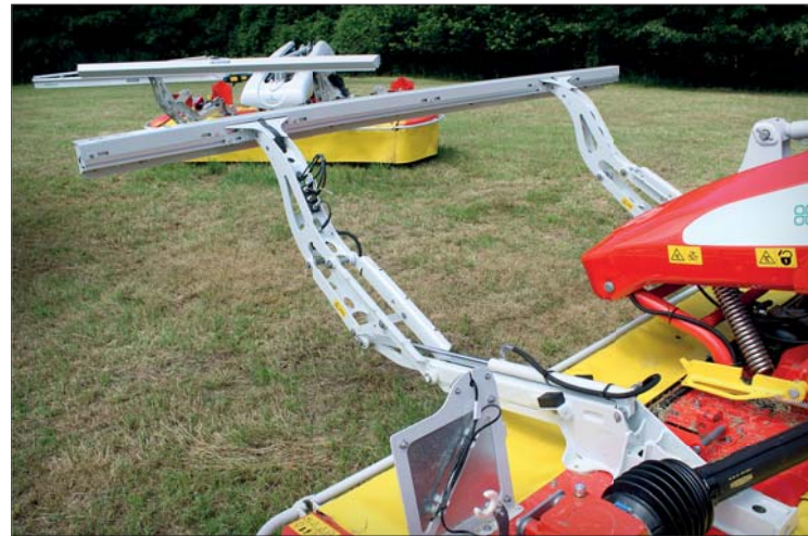
Na snímku je patrné, že i systém Sensosafe má svou přepravní a pracovní polohu, ovládanou hydraulicky
