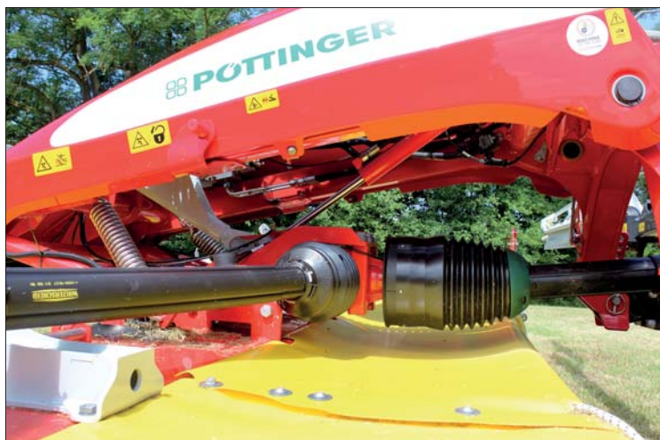
Zdvih čelního žacího stroje zabezpečuje integrovaná pístnice zdvihu na souvratích. Do okruhu je doplněn tlakový zásobník se stlačeným dusíkem
