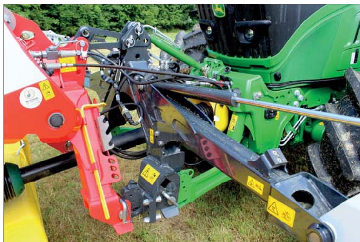
Nosník senzorů pro vzadu nesené žací stroje je uchycen do předního tříbodového závěsu traktoru. Pístnice slouží ke sklápění do transportní polohy
