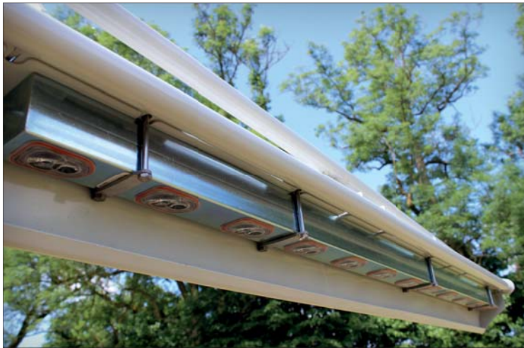
Senzory jsou uloženy v hliníkovém profilu a chráněny před poškozením
