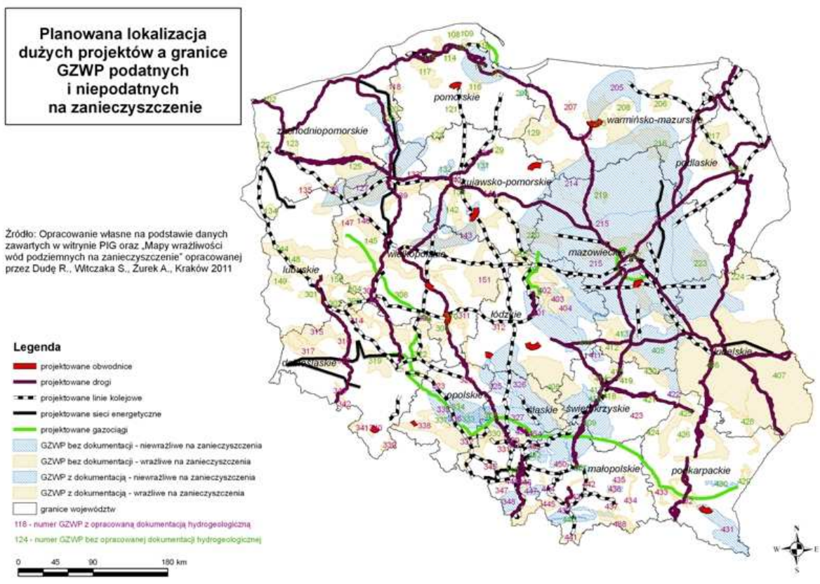
Rysunek 11. Lokalizacja „dużych projektów” liniowych POLIŚ względem GZWP. Kolorem różowym oznaczono GZWP wrażliwe na zanieczyszczenie. [Źródło: Opracowanie własne na podstawie danych zawartych w witrynie PIG oraz Mapy wrażliwości wód podziemnych na zanieczyszczenie 38 .
