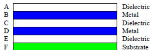
Figura 5.2 Struttura schematizzata di un assorbitore multistrato
