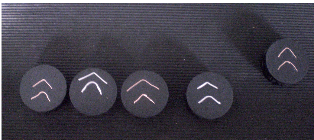
Figura 9.3 provini con materiali prima e dopo l'invecchiamento
