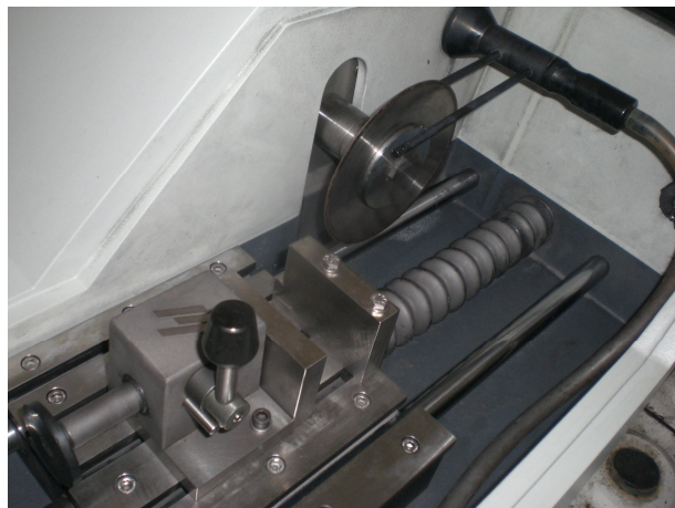
Figura 8.6 b Disco tagliente del microtomo
