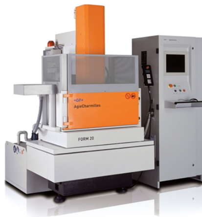
Figura 5.8: macchina per EDM a tuffo Form 20 (AgieCharmilles) [31].
