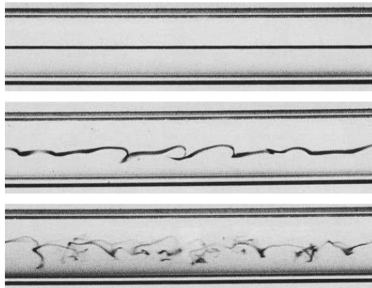
Figura 3.5: passaggio da moto laminare a turbolento nell'esperimento di Reynolds [45].
