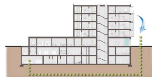
Fig.195 Schema concettuale del pre-trattamento dell'aria.
