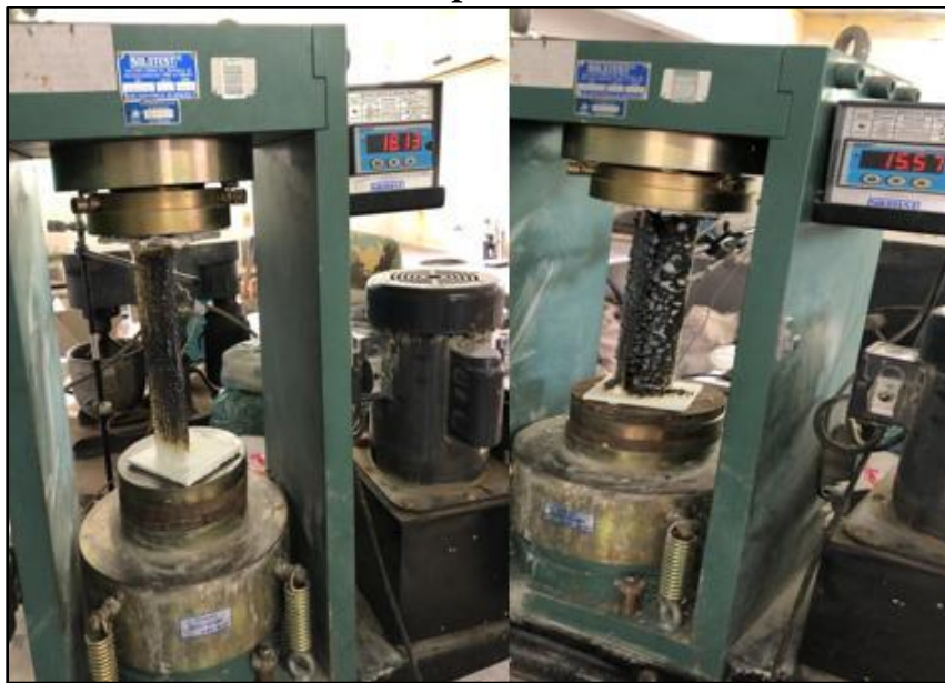
Figura 8 - Cantoneiras com tinta após ação do fogo e compressão
