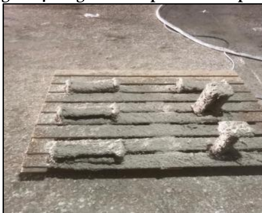
Figura 4 - Argamassa aplicada nos perfis
