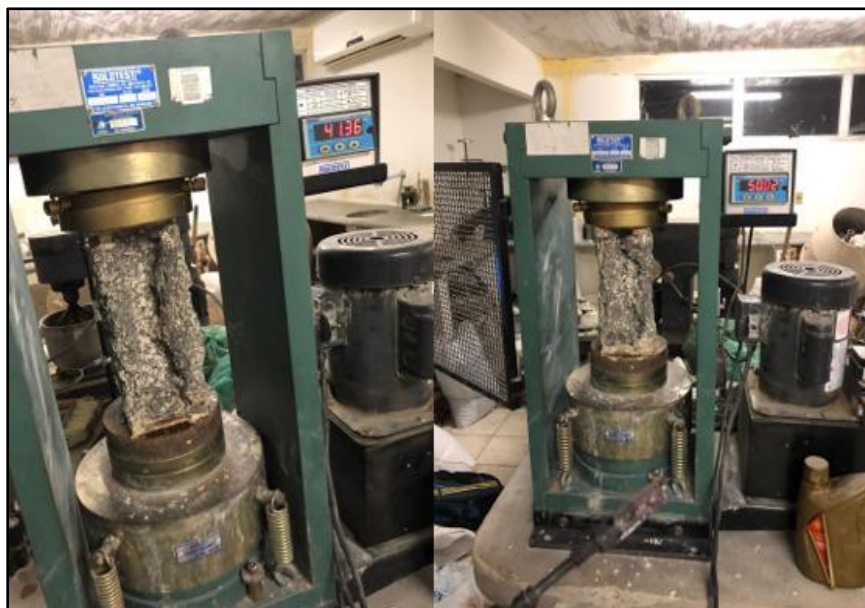
Figura 9 - Perfis I com argamassa após ensaio
