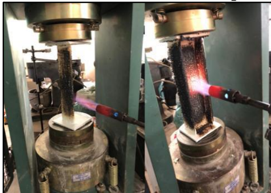
Figura 5 - Processo de intumescência nos perfis aquecidos
