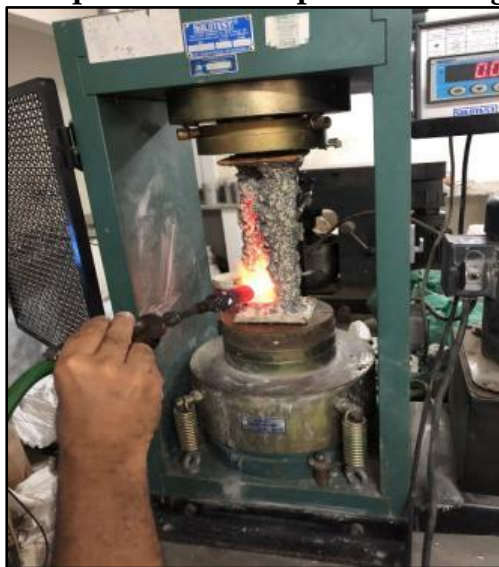
Figura 6 - Aquecimento de perfil com argamassa
