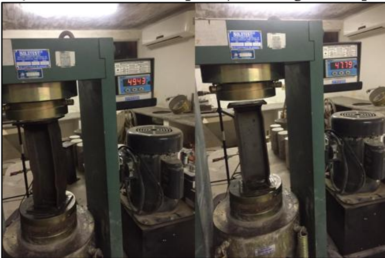
Figura 7 - Perfis I sem tinta após ação do fogo e compressão
