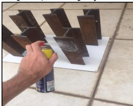
Figura 1 - Aplicação do spray antiferrugem
