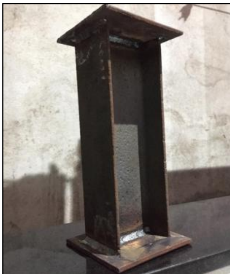
Figura 2 - Perfil I utilizado nos ensaios
