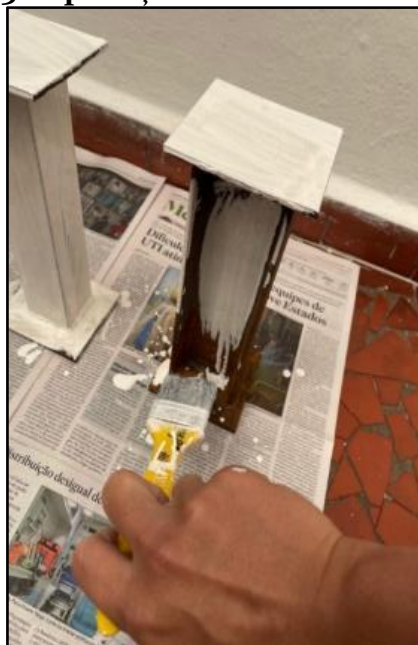
Figura 3 - Aplicação da tinta intumescente
