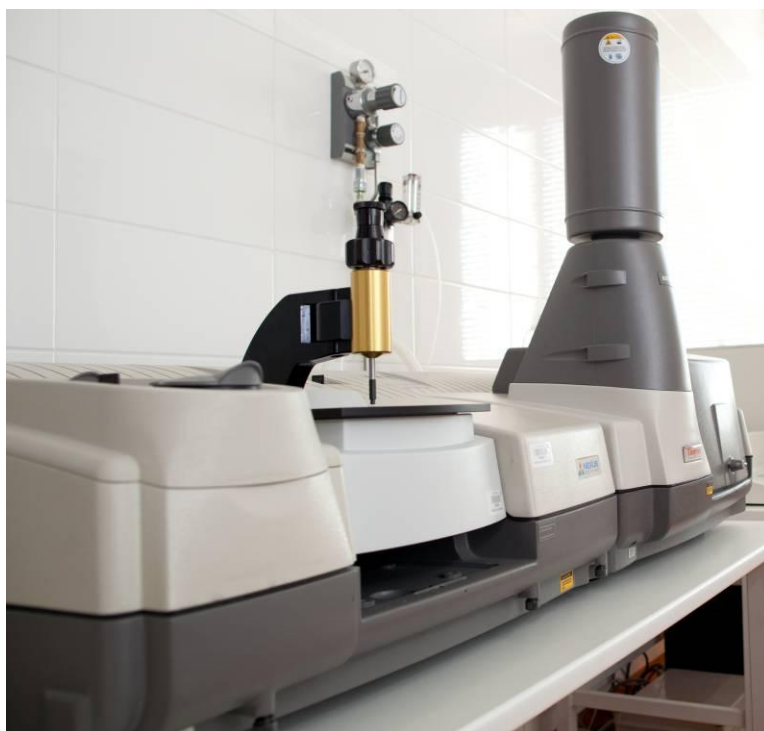
Obr. 40. NXR 9650 FT-Ramanův nástavec (v pozadí s kontejnerem na kapalný dusík pro chlazení detektoru) připojený k FT IČ spektrometru ThermoNicolet Nexus 670.
