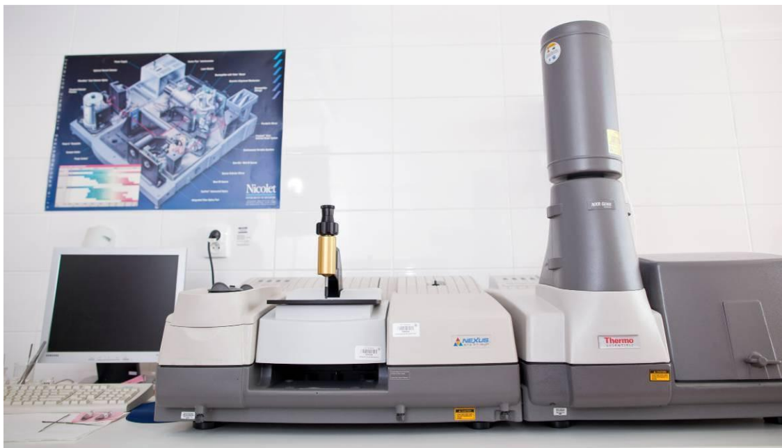
Obr. 26. FT infračervený spektrometr ThermoNicolet Nexus 670 (zde s ATR nástavcem) s NXR 9650 FT-Ramanových nástavcem (vpravo).
