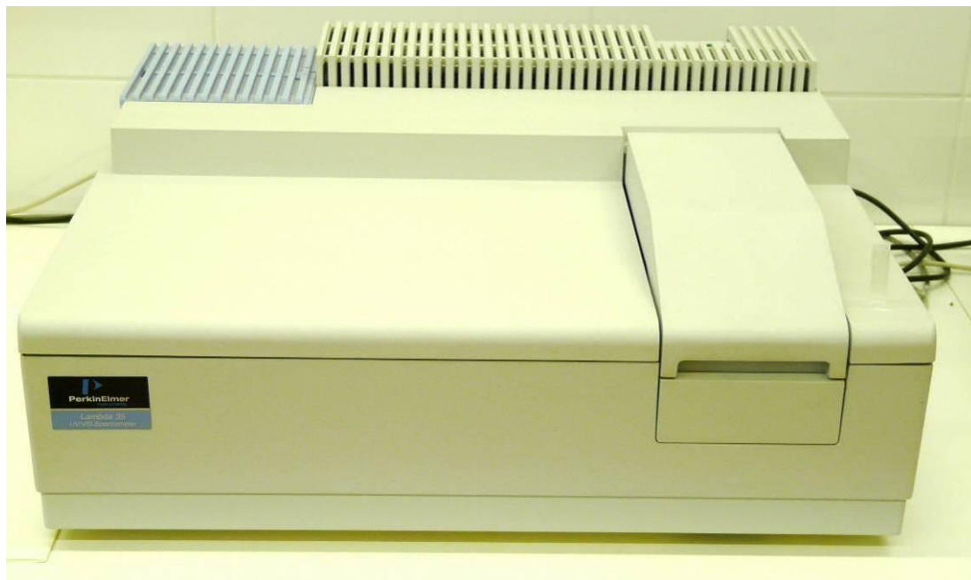
Obr. 8. UV-Vis spektrometr Perkin-Elmer Lambda 35 určený k měření roztokových spekter v oblasti 11000-40000 \text{cm}^{-1} , popřípadě difúzně-reflexních spekter vzorků v pevné fázi.
