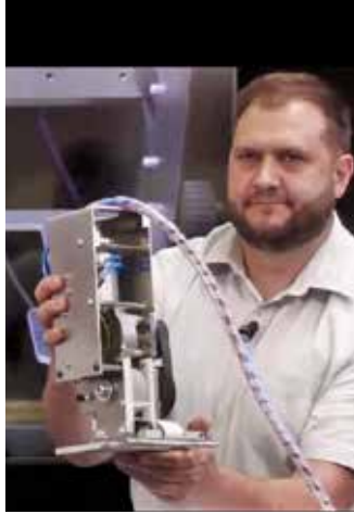
Tony Wolf von Popp präsentiert den Prototypen des innovativen Bandgreifers, der lückenloses Palettieren ermöglicht.
