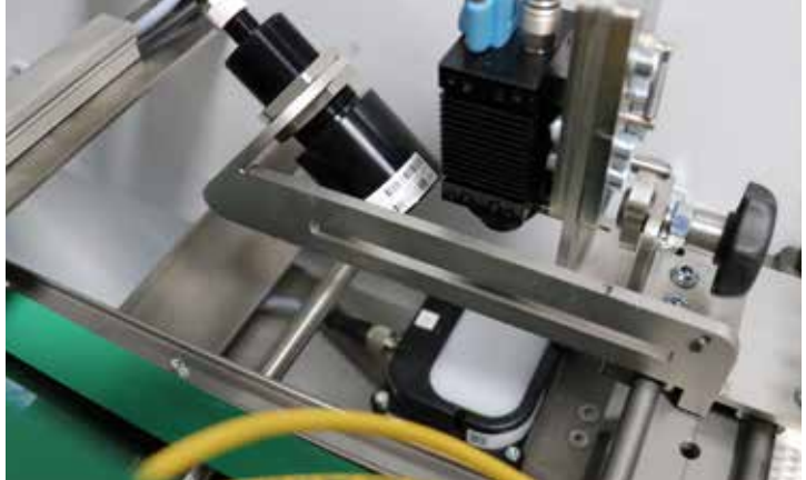
Kameras vermessen die Schneidmarkenposition relativ zur Papieraußenkante.
