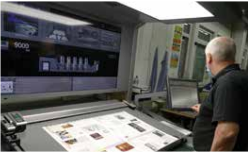
Ein 55-Zoll-Großbildschirm für den Leitstand ermöglicht die Überwachung der Druckqualität und des Betriebsstatus sowie die Echtzeitsicht der Bogenübergabe.
