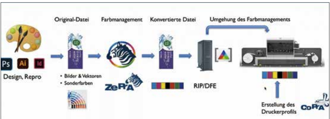
Diese Darstellung des Workflows zeigt, an welcher Stelle der Druckdatenerzeugung die Farbmanagement-Software ColorLogic ZePrA zum Einsatz kommt.
