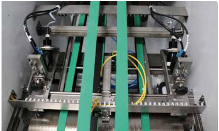
Unter kontrollierten Lichtverhältnissen prüfen zwei Kameras die Qualität der gefalzten Bogen.
