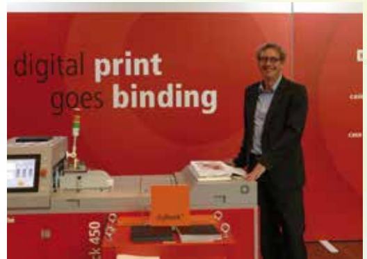
Jens Krüger von Digibook Technology führte die mitablock 450 für eine kostengünstige, vollautomatische Fertigung von digital gedruckten Lay-flat-Hardcover-Büchern vor.
