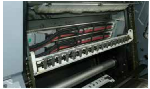
Zwei wassergekühlte, modulare Lampen-Arrays von GEW sind vollkommen abgedichtet, um eine einfache Reinigung und Widerstandsfähigkeit zu gewährleisten.
