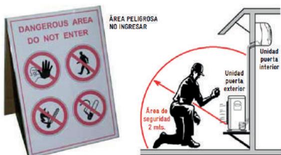
ILUSTRACIÓN 50. SEÑALIZACIÓN DE ÁREA DE TRABAJO.
