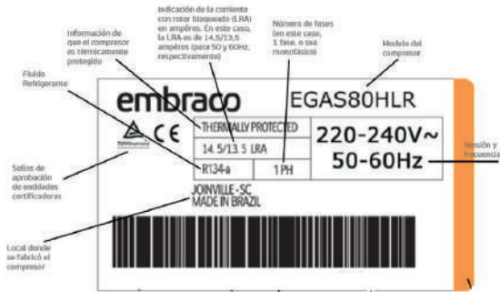
ILUSTRACIÓN 8. LA ETIQUETA DE UN COMPRESOR Y SU NOMENCLATURA EN UN EQUIPO RAC.
