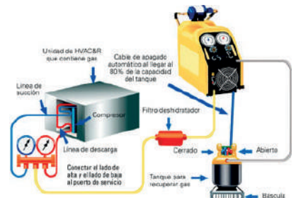
ILUSTRACIÓN 32. MÉTODO DE RECUPERACIÓN EN FASE LÍQUIDA.
