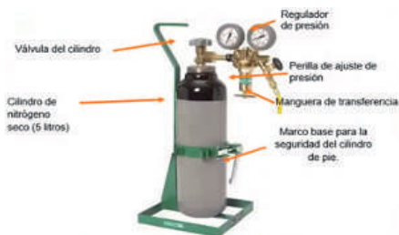
ILUSTRACIÓN 39. EQUIPO PARA EL USO DE NITRÓGENO SECO EN CAMPO.
