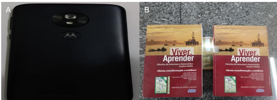
Figura 28 – (A) foto aparelho celular e lente convergente acoplada à câmera traseira, (B) foto do aparato formado por dois livros didáticos de cada lado que suportam a lâmina, com um celular como fonte luminosa abaixo dos livros. Autor: Luis Phillipe Carvalhais Leal.
