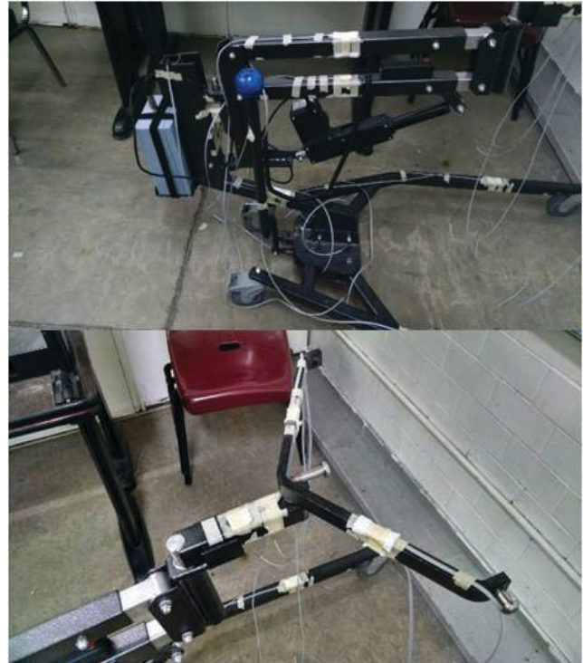
Fig. 11. Imágenes de la grúa completamente instrumentada con galgas extensométricas listas para ser utilizadas en las pruebas.
