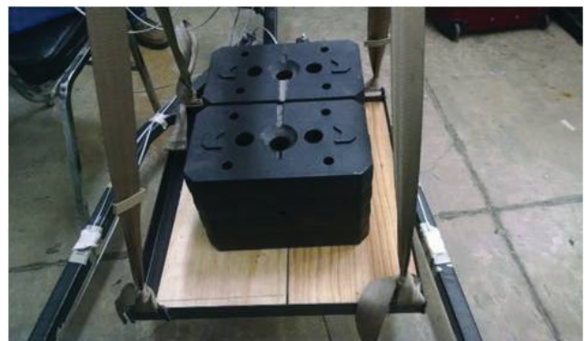
Fig. 12. Pesas utilizadas para la realización de las pruebas en la grúa.
