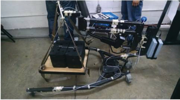
Fig. 13. Imagen de la grúa cargando 36 kg.
