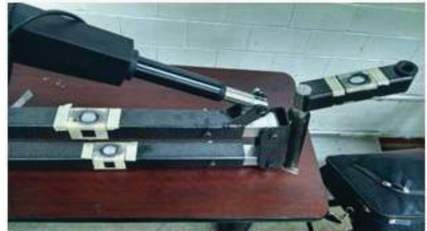
Fig. 3. Zonas de interés del marco, libres de pintura y listas para ser marcadas con los ejes de referencia para pegar las galgas.
