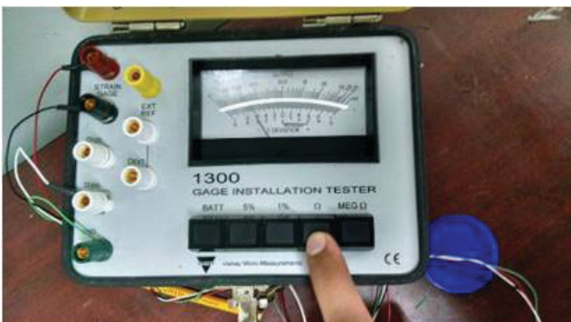
Fig. 10. Procedimiento para comprobar un correcto soldado de los alambres conductores en la galga.
