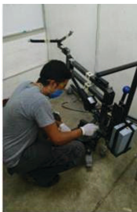
Fig. 2. Aplicación del removedor de pintura sobre las áreas en donde posteriormente se pegaron las galgas extensométricas.
