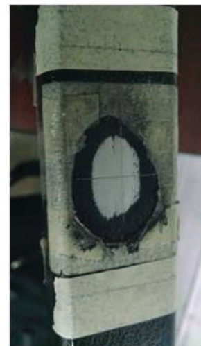
Fig. 4. Ejes de referencia marcados en una de las áreas que fue instrumentada con galga extensométrica.
