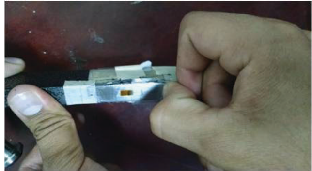
Fig. 7. Retiro de la cinta celofán de una de las galgas pegadas.
