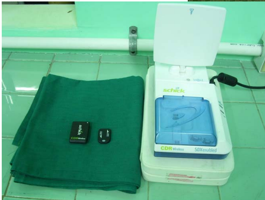
Foto 4. Equipo inalámbrico de captación de señal digital y placa intraoral (sensor) con su batería.
