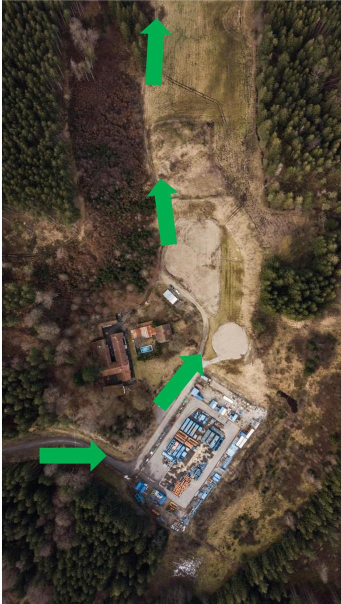
Abbildung 8: Fahrregelung als Einbahnstraßenregelung während Bohr- und Baubetrieb
