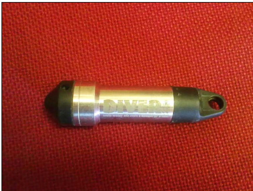
Figura II.28. Trasduttore di pressione utilizzato per il monitoraggio del livello dei canali.
