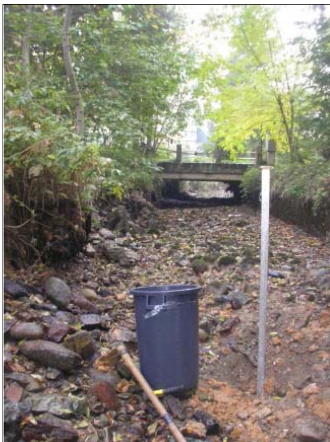
Figura III.102. Fotografia dell'esecuzione di una prova infiltrometrica sul fondo canale a canale secco.
