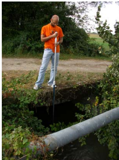
Figura III.145. Misura della velocità della corrente mediante mulinello idrometrico sulla Roggia Fraschetta.
