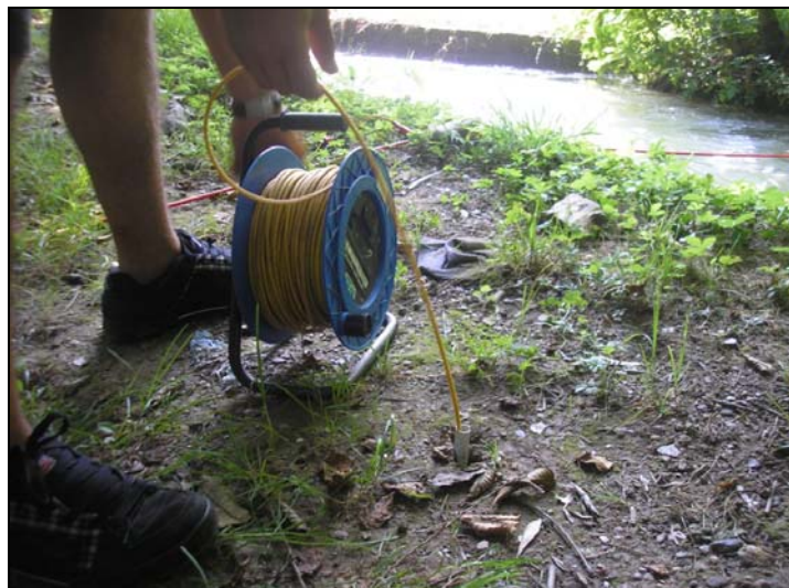
Figura II.4. Misura della soggiacenza delle acque sotterranee in una serie di micropiezometri infissi sulla sponda del canale Naviglio di Boves (CN).
