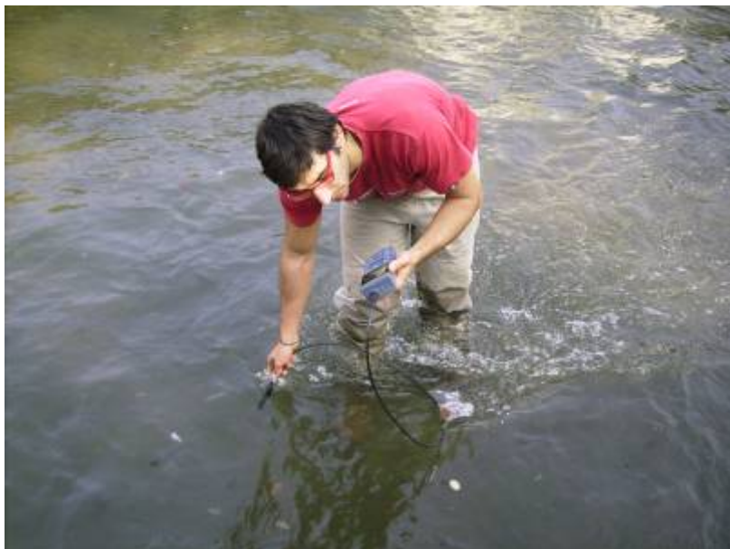
Figura III.31. Misura di conducibilità con conducimetro.
