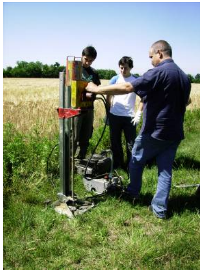
Figura III.40. Esecuzione della prova penetrometrica dinamica.
