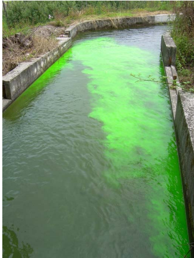
Figura II.23. Utilizzo della fluoresceina nei canali come tracciante.
