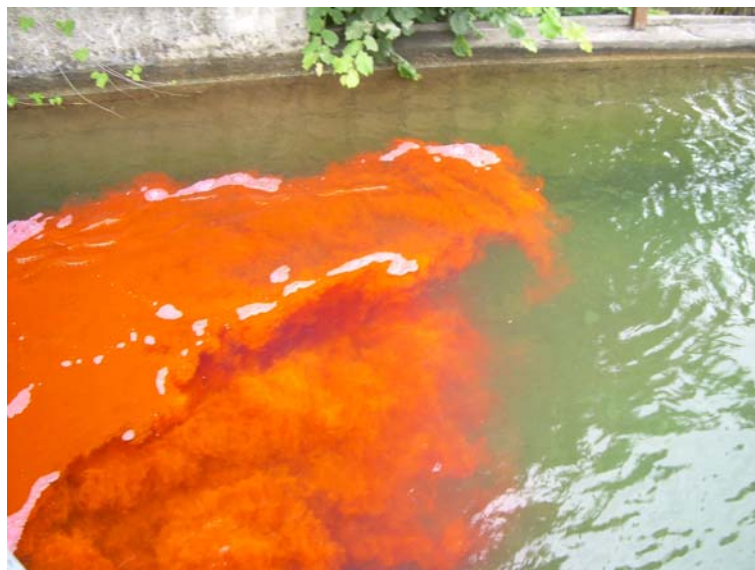
Figura II.24. Utilizzo della rodamina nei canali come tracciante.
