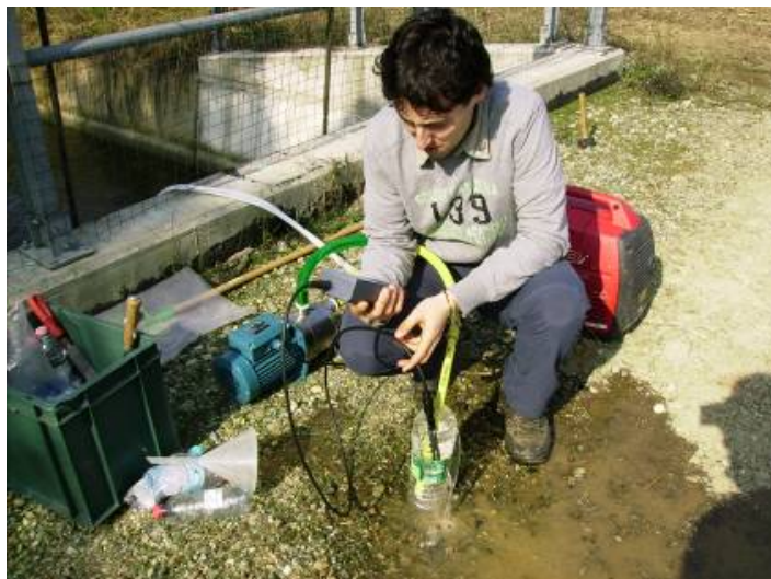
Figura III.34. Misura della conducibilità con il metodo del multicampionamento.
