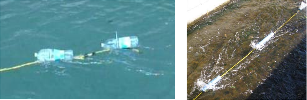
Figura IV.3. Immagini degli elementi galleggianti applicati al cavo e agli elettrodi.
