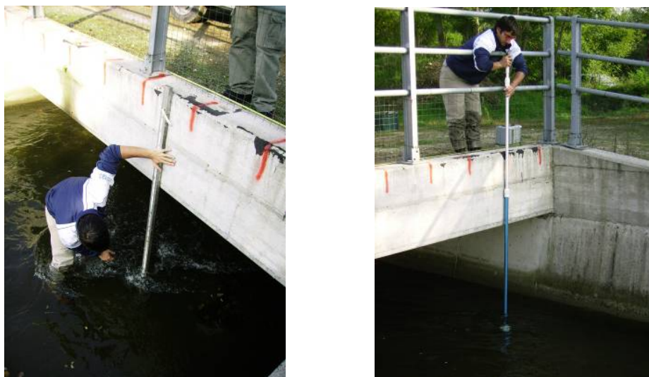
Figura III.24. Misura della profondità dell'alveo con asta graduata e misure di velocità della corrente con il mulinello.
