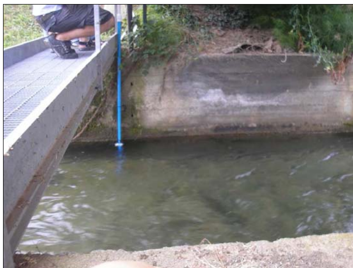
Figura III.95. Fotografia del mulinello in azione lungo la sezione intermedia del tratto di canale indagato.
