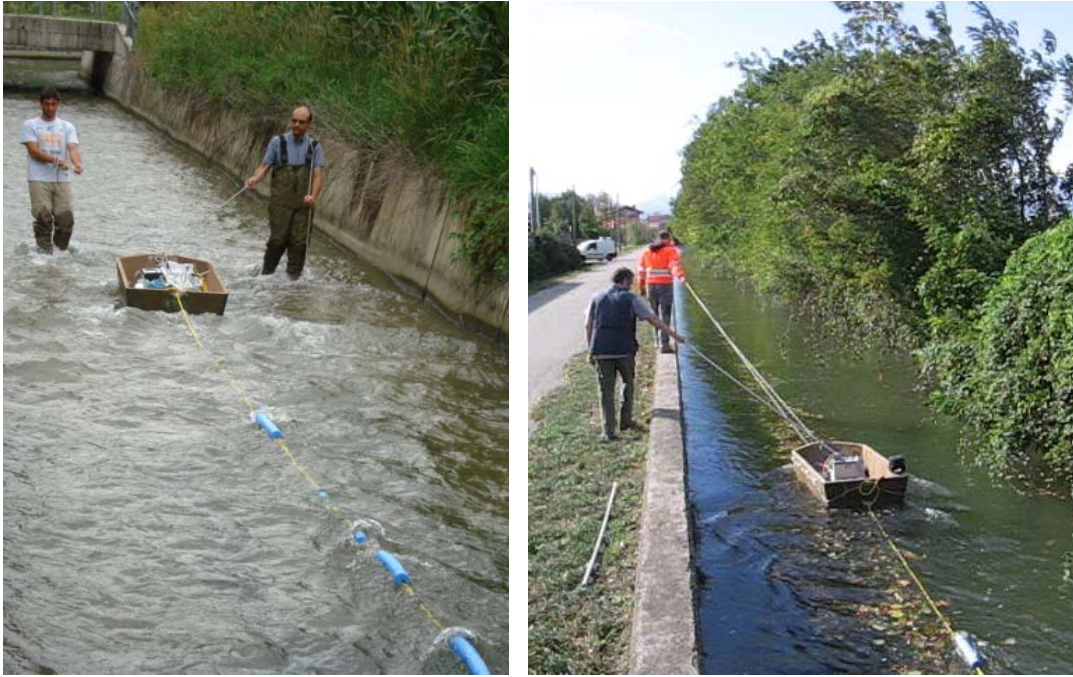
Figura IV.5. Immagini del natante trascinato dagli operatori sia direttamente in alveo che da sponda.
