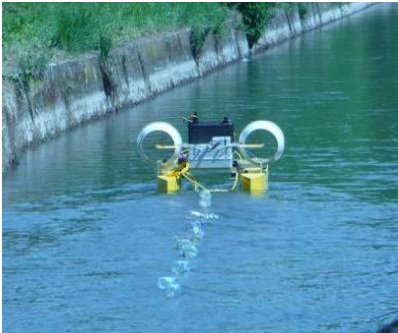
Figura IV.4. Immagine del natante radiocomandato da sponda e del cavo elettrodo trascinato.
