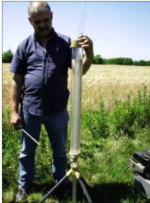
Figura II.8. Prova infiltrometrica con permeametro Guelph nei pressi del Canale di Caluso (Tonengo di Mazzè, TO).
