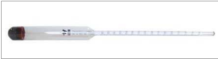
Figura II.6. Densimetro impiegato per la realizzazione della prova.
