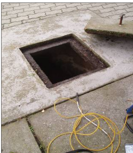
Figura III.61. Misurazione della soggiacenza presso il pozzo CHS.
