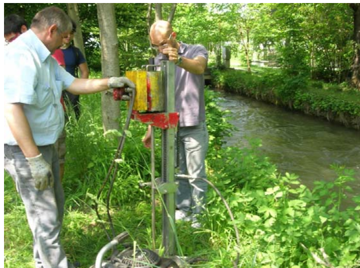
Figura II.9. Prova penetrometrica presso il Naviglio di Boves.
