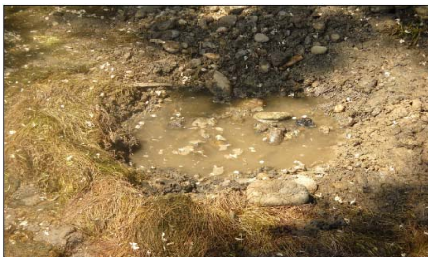
Figura III. 146. Scavo nel fondale del Naviglio di Bra per il campionamento del materiale.
