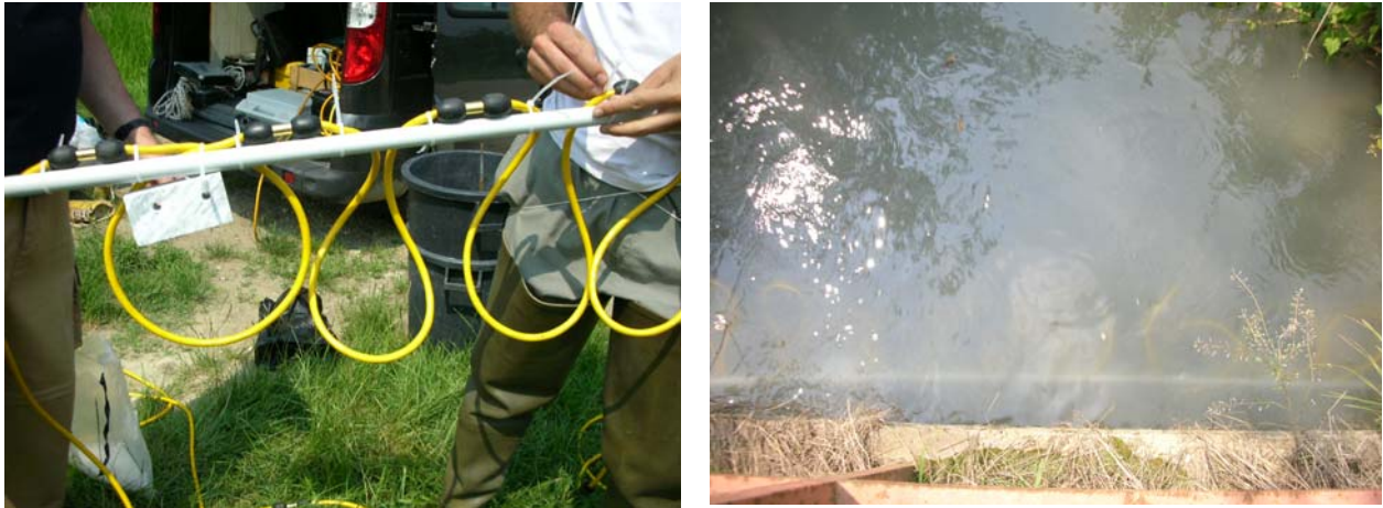
Figura IV.8. Immagini del cavo, del posizionamento degli elettrodi e dell'ancoraggio sul fondo del canale dell'apparato.
