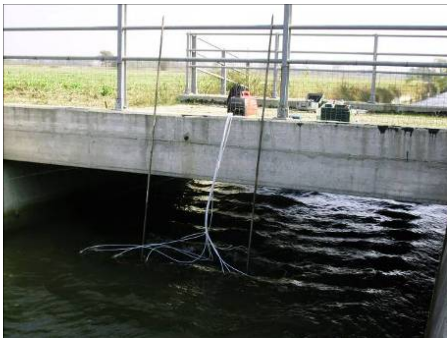
Figura II.21. Sistema di multicampionamento attraverso una incastellatura di aste e tubicini.
