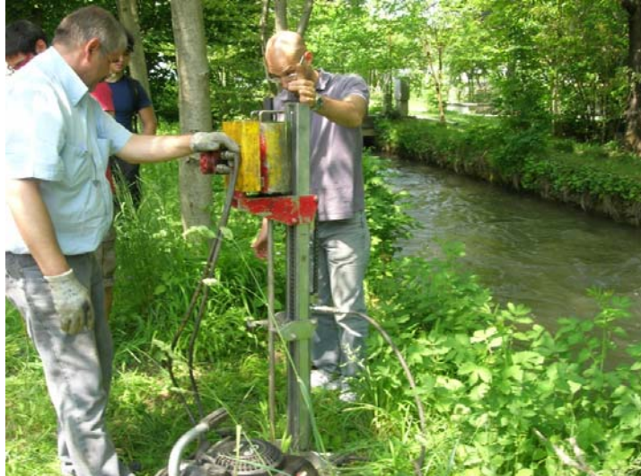
Fig. III.103. Esecuzione di una prova penetrometrica lungo la sponda destra del canale.
