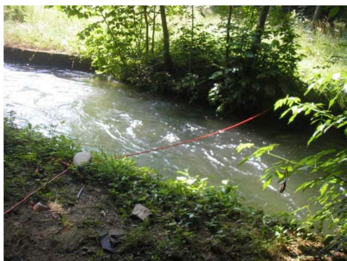
Figura III.92. Particolare della tomografia elettrica eseguita perpendicolarmente al corso del canale.
