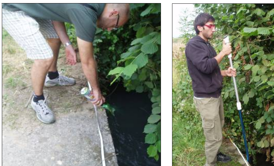
Figure III.66/67 Suddivisione in conci per la misura della sezione del canale e misura della velocità della corrente mediante mulinello idrometrico.
