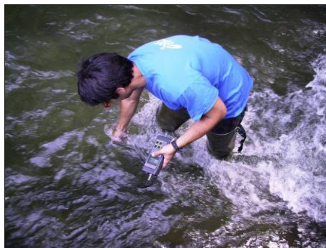
Figura II.17. Misura della conducibilità durante una prova di tracciamento sul Canale di Caluso (Tonengo di Mazzè, TO).
