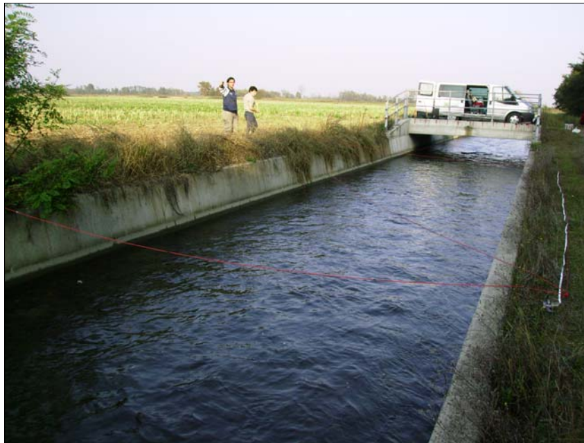
Figura II.14. Misura di velocità superficiale con il metodo dei galleggianti su un tratto del Canale di Caluso.
