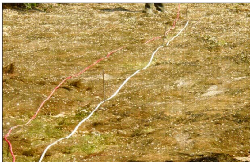
Figura III.128. Prima tomografia elettrica parallela al canale (Stendimento 1).
