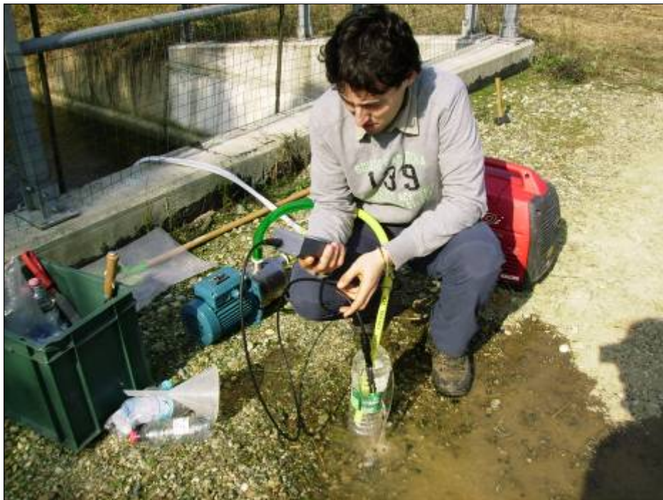
Figura II.22. Sistema di multicampionamento con pompa autoadescante.
