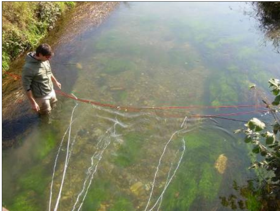
Figura II.20. Sistema di multicampionamento attraverso una maglia di catene e tubicini.
