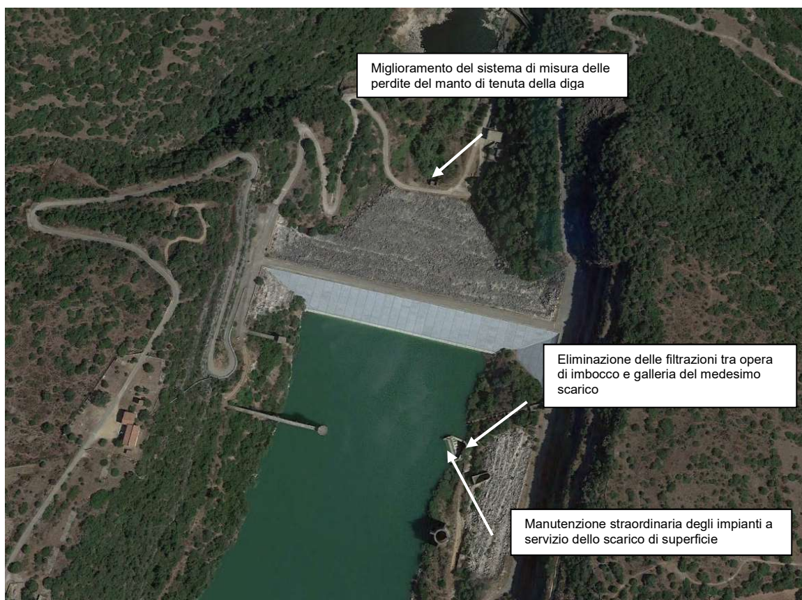
Figura 9-Individuazione degli interventi da realizzare
