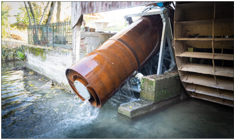
La vis hydrodynamique d'Helliogreen Industrie dont 14 autres éléments seront réalisés à AFS à Sedan va simplifier la production d'énergie renouvelable sur les petites et moyennes chutes d'eau.
