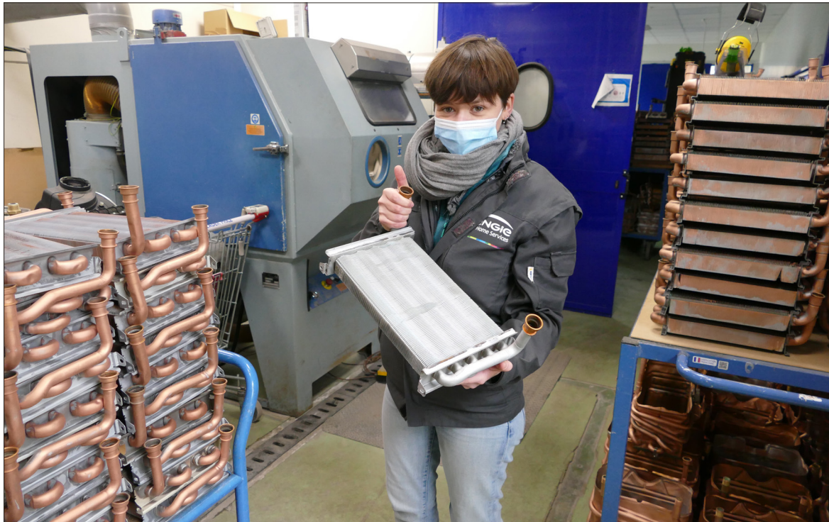
Marine Lourenço, Responsable QSE chez Engie home services, présente un corps de chauffe nettoyé et passé à la sableuse.
