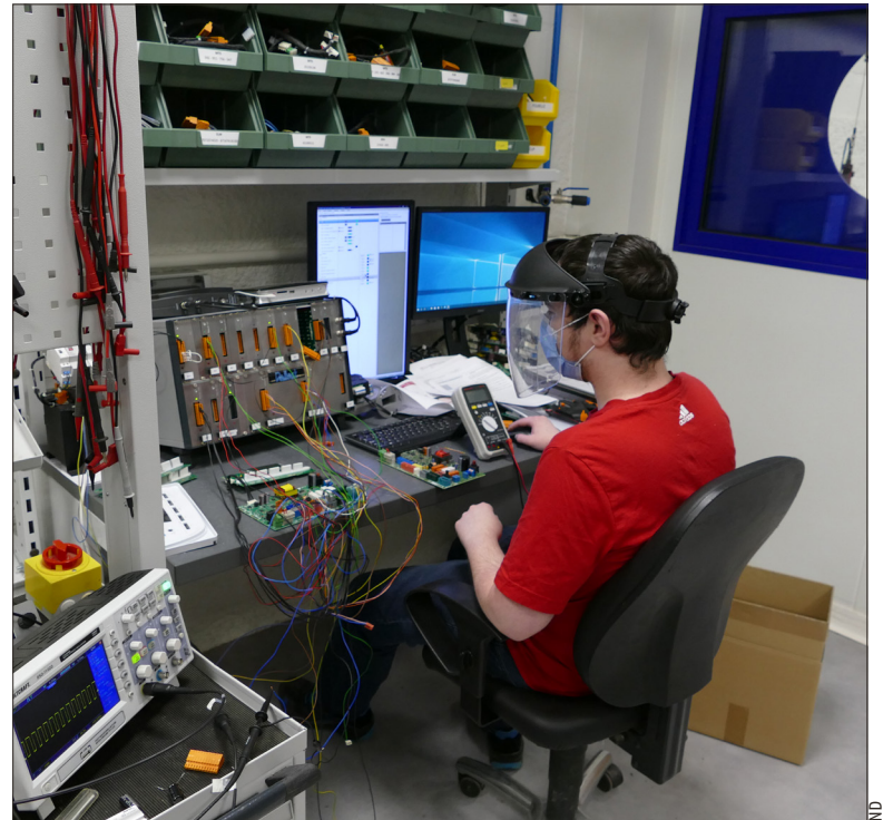
Les cartes à puces des chaudières endommagées sont entièrement restaurées et testées dans l'atelier par un électrotechnicien.
