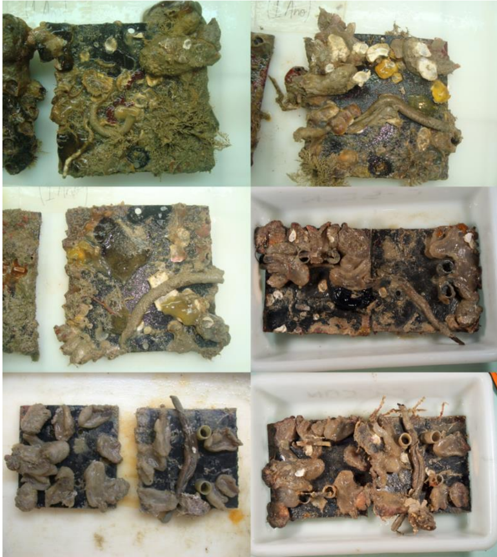
Figura 7 – Placas do fouling após um ano de submersão, mostrando tubos de sabelídeos.
