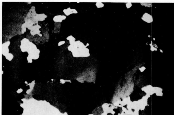
Fig. 83. Inhomogene Verzerrungen im Korninneren, teilweise genügend, um primäre Rekristallisation zu provozieren. Bedingungen: T = -1,9^{\circ} \text{C} , \sigma_0 = 16,0 \text{ kg} \cdot \text{cm}^{-2} , \dot{\epsilon}_3 = 1,74 \cdot 10^{-5} \text{ sec}^{-1} , unmittelbar nach Versuchsabbruch. Vergrößerung 10\times .
