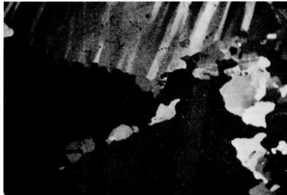
Fig. 75. «Dehnungs-induzierte» Korngrenzenverschiebung, die gegen inhomogene Verzerrungen vorstößt. Bedingungen: T = 1,9^{\circ} \text{ C} , \sigma_0 = 16,0 \text{ kg} \cdot \text{cm}^{-2} , \dot{\varepsilon}_3 = 1,74 \cdot 10^{-5} \text{ sec}^{-1} . Vergrößerung 10\times .
