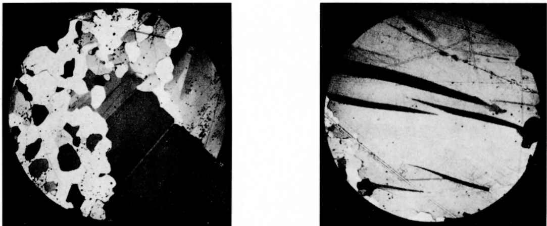
Fig. 76. Knickbildung in anomal großen Körnern des parakinematischen Rekristallisationsgefüges. Bedingungen: T = -1,9^{\circ} \text{ C} , \sigma_0 = 14,8 \text{ kg} \cdot \text{cm}^{-2} , \dot{\varepsilon}_3 = 1,09 \cdot 10^{-5} \text{ sec}^{-1} . Vergrößerung 9\times .
