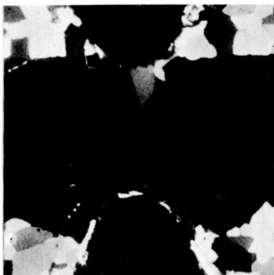
Fig. 71. Ausbreitung einer inhomogenen Verzerrung in einem verspannten Bikristall, der Gleitung nach (0001) ausschließt. Vergrößerung 4\times .
