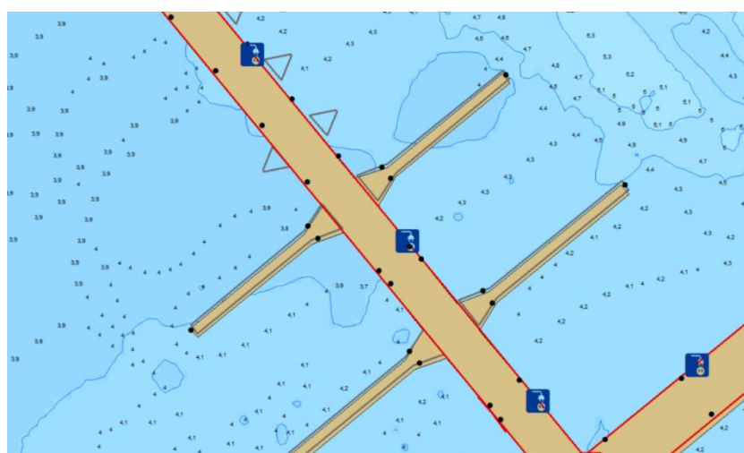
Rys. 16. Uzupełnienie ENC o brakujące pomosty.
