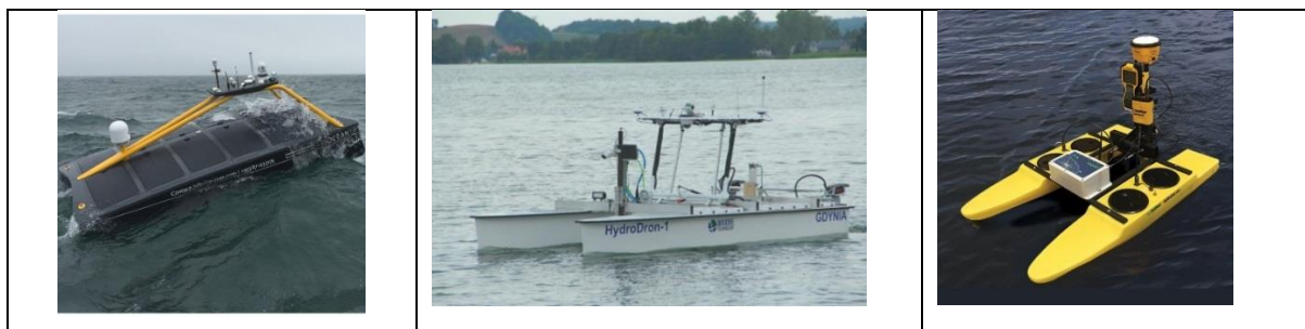
Rys. 1. Bezzałogowe jednostki USV: wielofunkcyjna jednostka (4.5mx2.2m, 750 kg) xoclean [xoclean.com] (rys. lewy), dwukadłubowy (4mx2m, 350 kg) HydroDron-1 (środek), mała jednostka Seafloor system (rys. prawy) (1.1mx0.7m, 18 kg).
