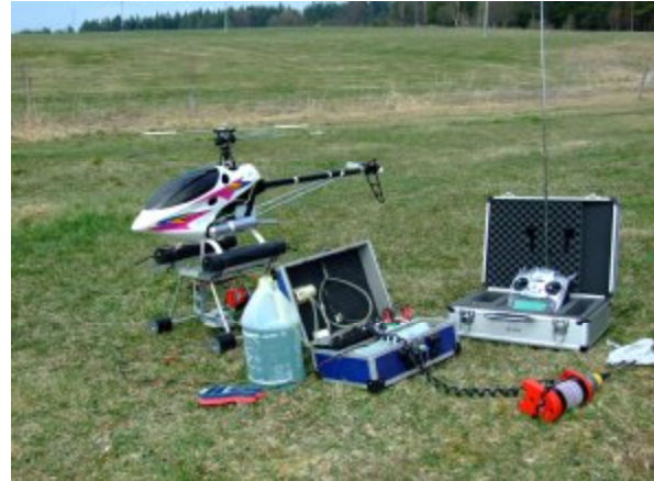
Obr. 7 Vlevo: Měření vodních stavů ultrazvukovou sondou. Vpravo: Snímkovací model vrtulníku. Foto: Kliment
