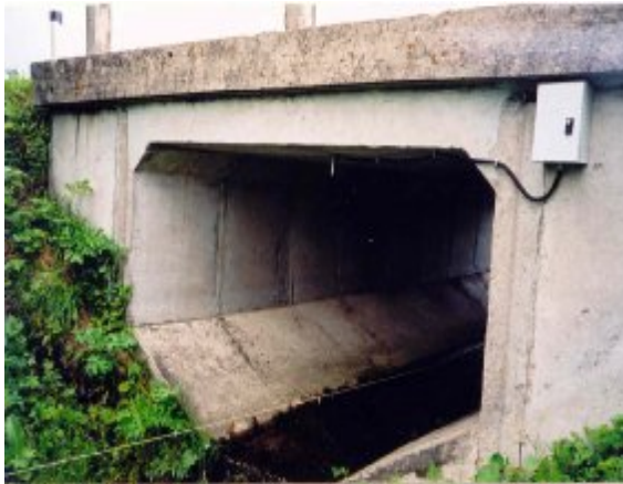
Obr. 7 Vlevo: Měření vodních stavů ultrazvukovou sondou. Vpravo: Snímkovací model vrtulníku. Foto: Kliment
