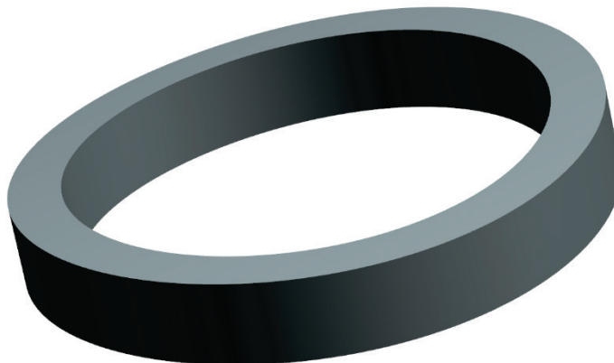
Figur 5. Toroid utskuren från ett DN700 rör.
